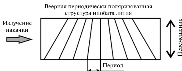
Рис. 2. Топология веерной периодически поляризованной структуры ниобата лития.
